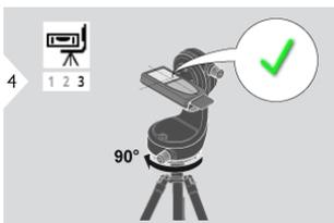
Girar el dispositivo en la dirección de las agujas del reloj 90°. Siga las instrucciones del display. La nivelación finaliza cuando aparece el icono OK en la pantalla.
